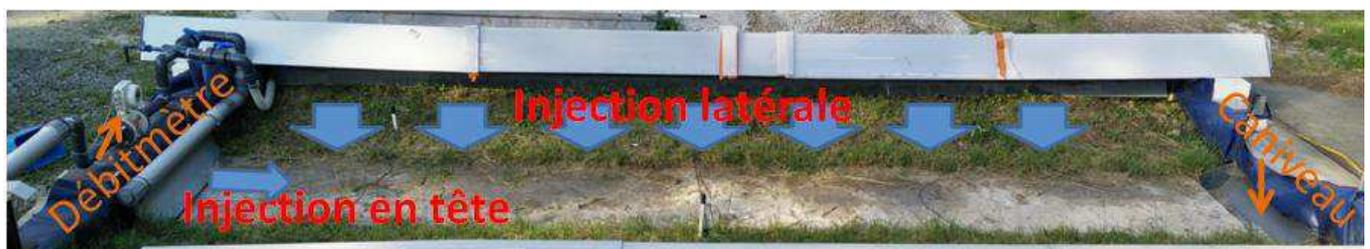
Figure 1. Dispositif d'alimentation de la noue d'infiltration.
